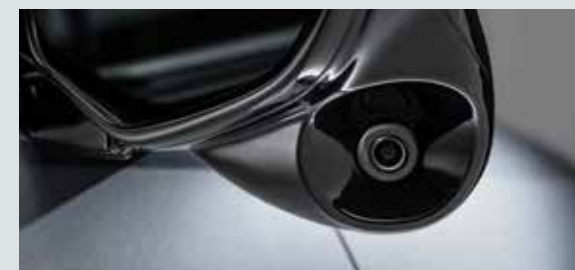
Камера системи контролю за смугою в бічному правому дзеркалі (LaneWatch) з виведенням на 8-дюймовий дисплей мультимедійної системи Honda Connect і камера заднього виду з трьома режимами виведення зображення (нормальний, ширококутний і вид зверху).
