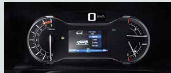
Інтелектуальна система управління тягою (ITM) дозволяє вибрати один з режимів роботи: «Сніг», «Бруд», «Пісок».
