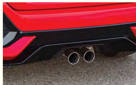
Подвоєні патрубки випускної системи (для Sport та Sport Plus)
